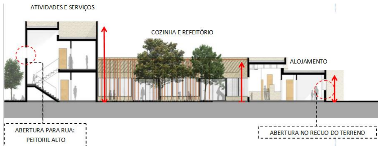
Figura 7. corte esquemático sinalizando as aberturas do edifício
